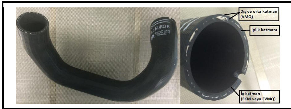
Şekil 1. Turbo hortum yapısı.
